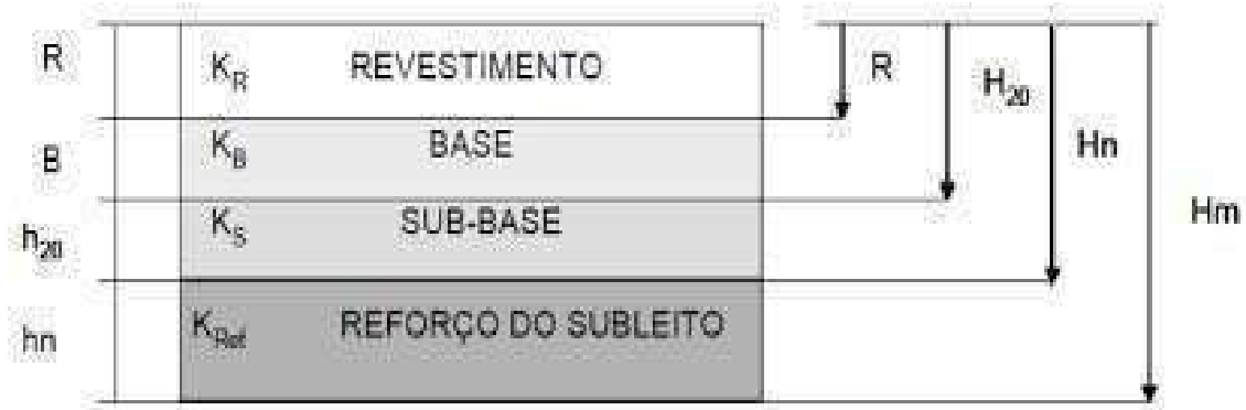
Figura 03. Dimensionamento de pavimento flexível
